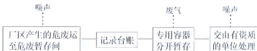
图 2-3 项目危废暂存工艺流程图
