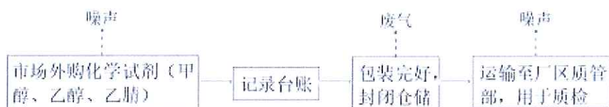
图 2-2 项目化学药品储存工艺流程图
